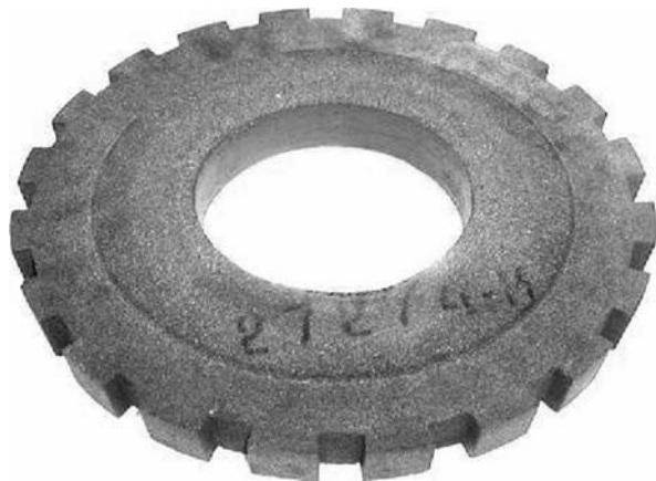
Рис. 1.1. Дискретный цельный круг с режущими выступами и впадинами
